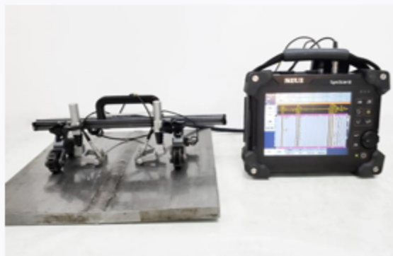
②TOFD超声波探伤仪
