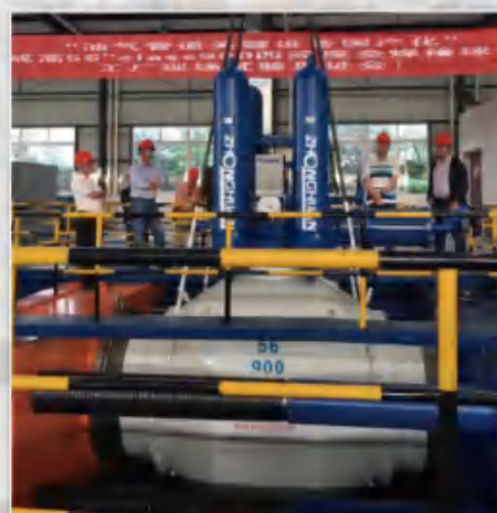
56"-900LB四阀座全焊接球阀工厂试验
