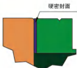
(b) 硬密封阀座结构
