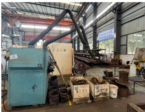
图 2-1 焊烟净化器
