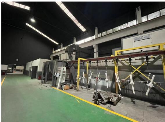
图 2-3 悬挂式喷漆流水线
