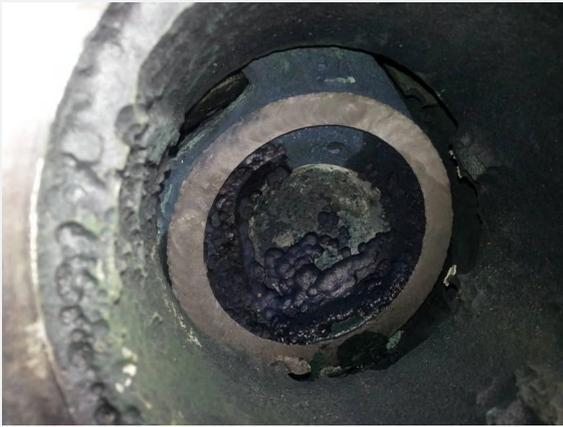
图1 321不锈钢汽提阀门内部腐蚀情况
