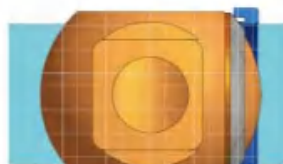
8. 继续转动手轮，阀杆再次下降机械挤压球体与阀座紧密接触
