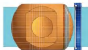
7. 继续转动手轮，阀杆和球体在与阀座完全无摩擦的情况下转至90°
