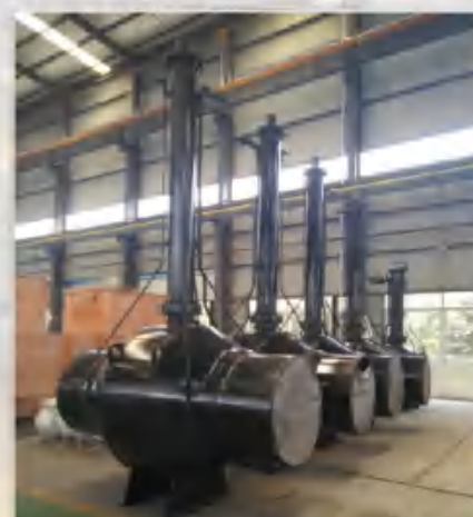
埋地四阀座全焊接球阀
