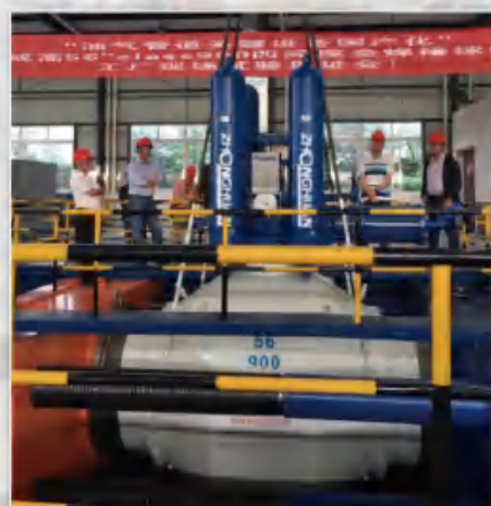
56"-900LB四阀座全焊接球阀工厂试验
