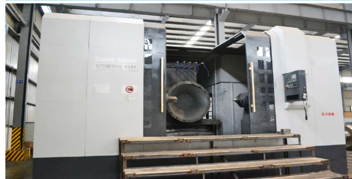
精密数控球体球面磨床 [有效加工尺寸：36寸-56寸]
