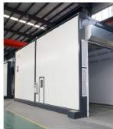
PQYD12*6-2大型移动式喷漆烘干装置
