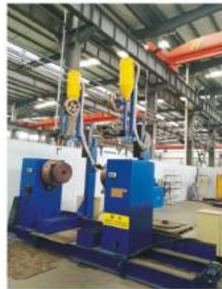
GXB-TMII 阀体环缝自动焊机 [有效工作尺寸：2000]
