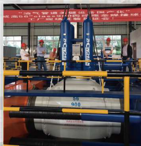
56"-900LB四阀座全焊接球阀工厂试验
