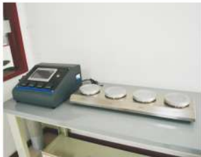
晶间腐蚀设备
